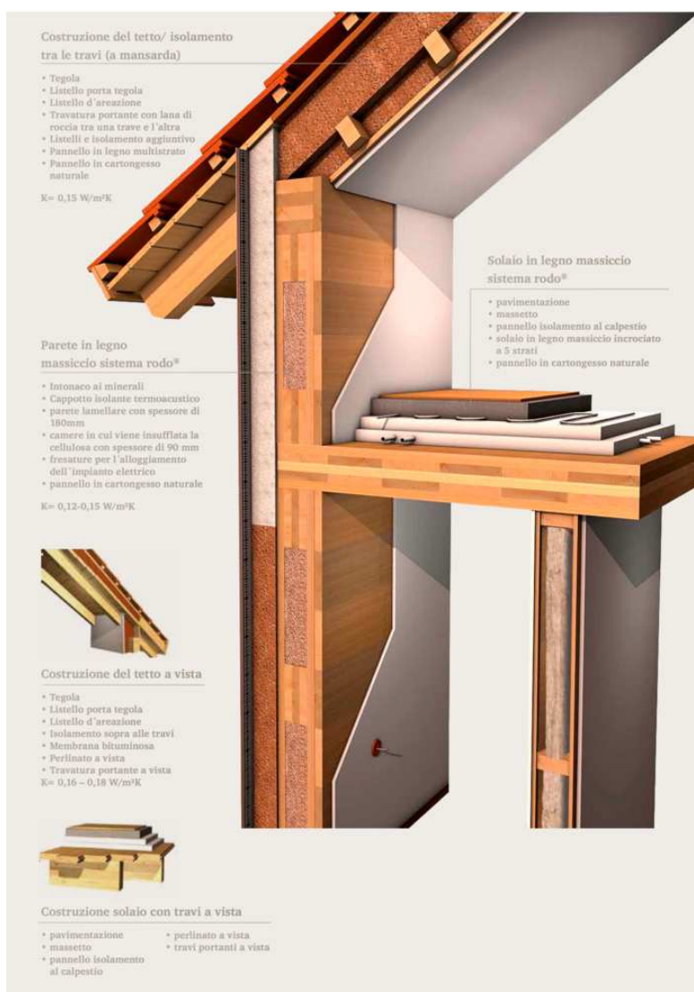
Figura 1: soluzioni per l'isolamento interno del tetto
